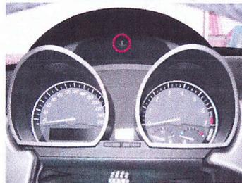
Die Instrumenteneinheit ist mit einem Stecker angeschlossen. Lösen Sie diesen nach dem selben Prinzip, wie schon der Stecker des Steuergeräts abgezogen wurde. (Verriegelungshaken herunterdrücken und Bügel auf die Seite klappen). Nun können Sie die Instrumenteneinheit seitlich am Lenkrad vorbei entfernen.
