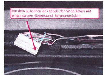
Stecken sie nun anstelle des bisherigen Kabels das Ende des „gelb/grünen“ Kabels Ihres Moduls in das Steckergehäuse. Das Ursprüngliche Kabel stecken Sie an das „gelbe“ Kabel des Kabelbaums und sichern den Kontakt mit dem beigelegten Schrumpfschlauch.
